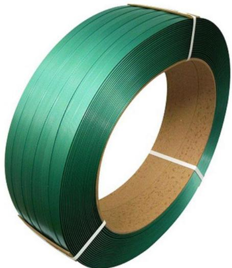
As Fitas de Arquear PET são utilizadas para arqueação em paletes e em produtos pesados que necessitam de uma alta resistência a rupturas e alto nível de tensionamento. Em alguns casos, é possível substituir a Fita de Aço pela Fita de Arquear em PET devido a sua maior segurança na aplicação e facilidade na armazenagem.
